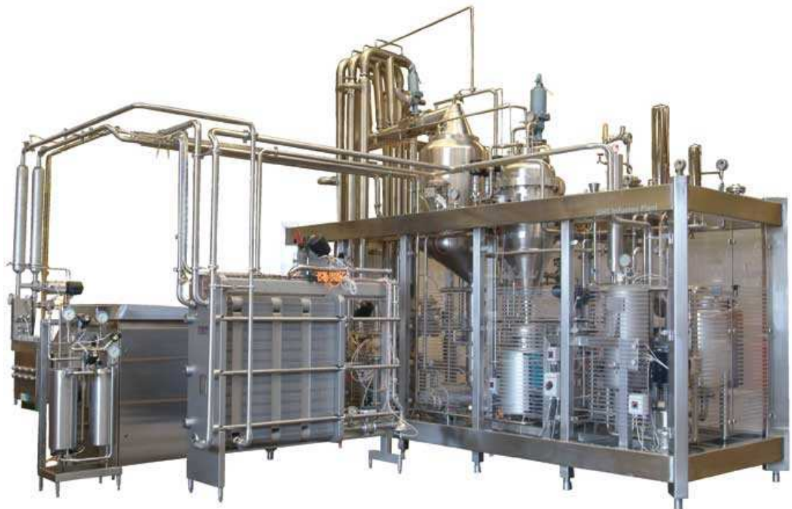
Figura 4.1 Impianto U.H.T. A.P.V. tipo SDH, ad infusione diretta di vapore (Sito web A.P.V. [a], 2013).
