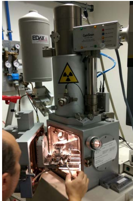
Figura 3.19: Microscopio a scansione elettronico utilizzato per effettuare le misure SEM
