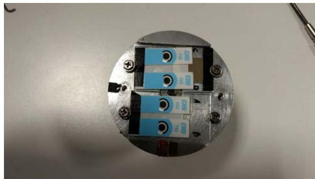
Figura 3.20: Immagine del tamburo su cui sono fissati i dispositivi campione ricoperti da del nastro conduttivo
