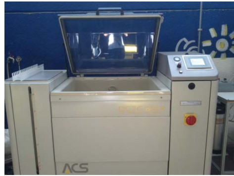
(d) Camera test nebbia salina.
