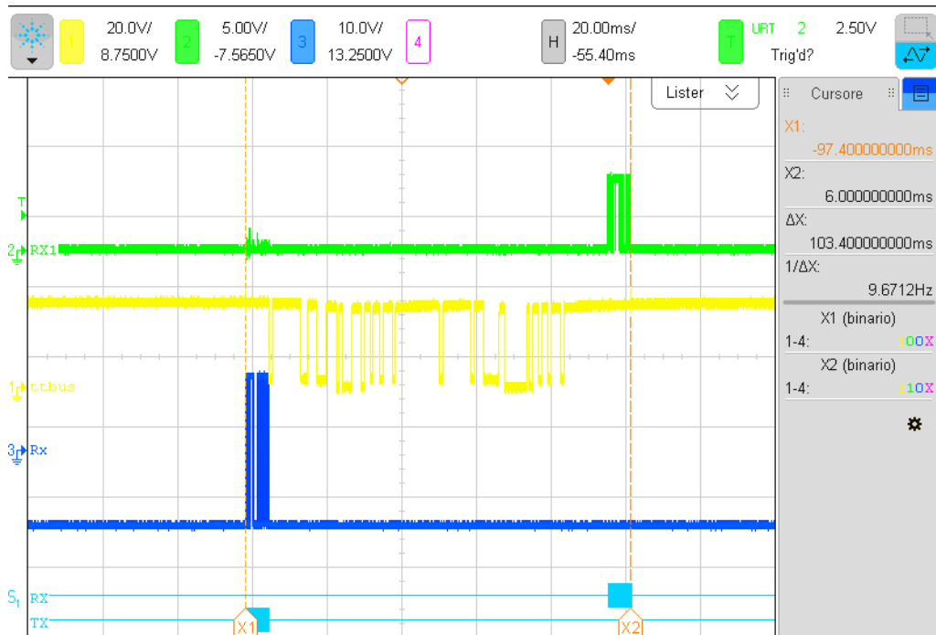
Figura 4.4: Segnali presenti su seriale e TTBUS durante la procedura di memorizzazione del telecomando con firmware modificato.
