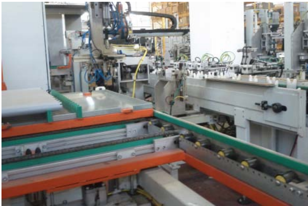
Figura 2.6: Ingresso dei motori nella macchina System Electric
