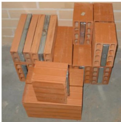
Figura 4.3.1 – Esempio di applicazione; il PCM è stato incorporato mediante incapsulazione all'interno dei mattoni. [3]
