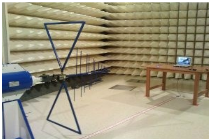
Figura 3.1: esempio di misurazione in SAC, da notare l'antenna bilog e l'EUT a distanza
