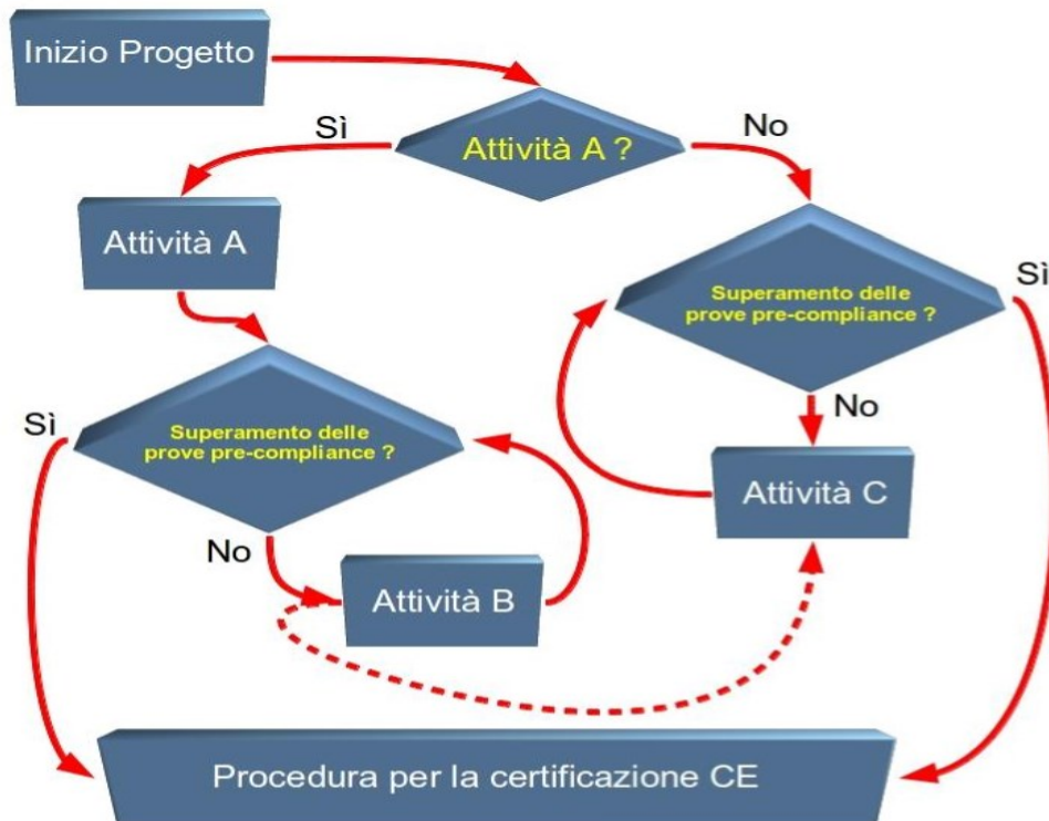
Figura 5.1: diagramma che riporta i possibili iter da seguire per una corretta progettazione. Il percorso migliore è quello che prevede l'attività A
