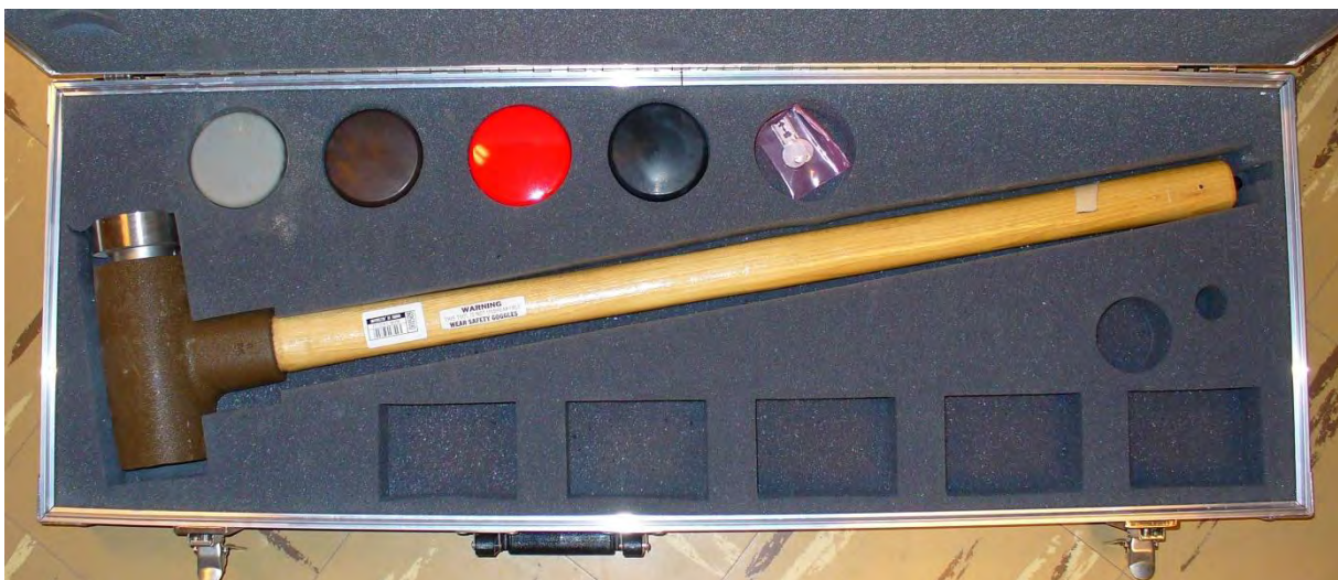
7.17 Martello strumentato piezoelettrico con punte correlate
