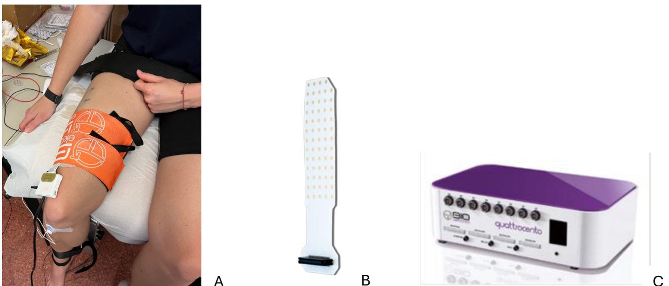
Fig.3 Nella figura A è presentato il dinamometro isometrico ed il set up sperimentale. Nell'immagine B è raffigurata a matrice adesiva con 64 elettrodi, con una distanza interelettroica di 8 mm (13 righe - 5 colonne): nel pannello C un'immagine della cella di carico utilizzata per acquisire il segnale di forza; nel pannello C è presentato il Ouattrocento, amplificatore di segnali bioelettrici a 400 canali utilizzato per amplificare e registrare i segnali elettromiografici di superficie dal muscolo vasto laterale durante l'estensione di ginocchio isometrica.
