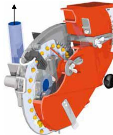
**Figura 1.6** particolare di una seminatrice: schema di rilascio del seme e tubo dell'aria in uscita (rappresentato dalla freccia)
