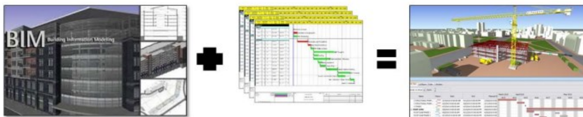
Figura 15 – Modello 3D BIM + cronoprogramma = modello 4D BIM (immagine tratta da Fucelli & Fabio, 2017)
