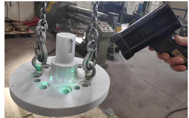
Il test, che consiste nella misurazione dei diametri, delle circonferenze, della coassialità e della planarità di un corpo pompa, è stato eseguito tramite l'utilizzo del faro o Laser Scanner; esso è uno strumento laser in grado di rilevare misure di lunghezza, ma anche circonferenze, posizione degli assi di cilindri, ecc.
