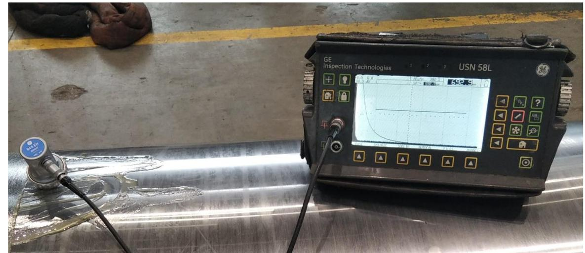
Per l'ispezione con raggio normale quando l'onda viaggia all'interno del pezzo da analizzare ed incontra una discontinuità, parte dell'energia sarà riflessa e la rimanente parte sarà trasmessa nel materiale.
