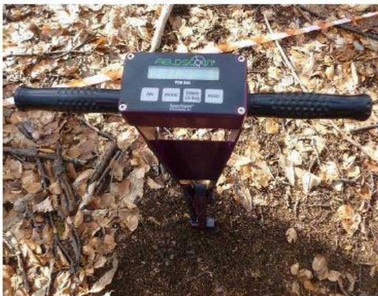
*Figura 3.3. La sonda TDR 300 di umidità del suolo.*
