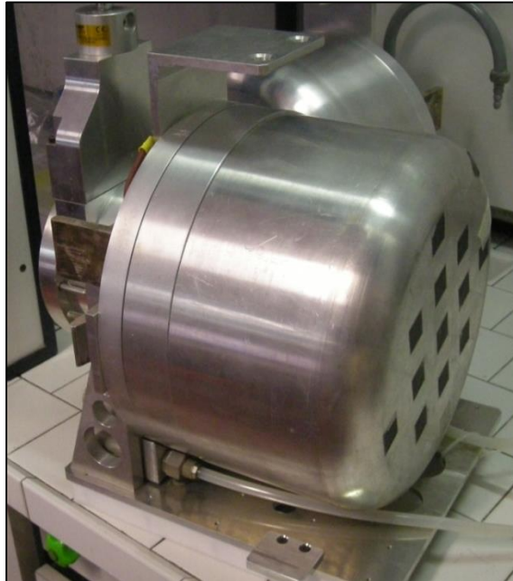
Figura 5-2: Camera da vuoto utilizzata per la sorgente PIS. Il coperchio non è raffreddato ad acqua, si utilizzano dei getti d'aria compressa per evitare che le zone vicine agli O-ring rimangano a temperature superiori ai 100 °C.
