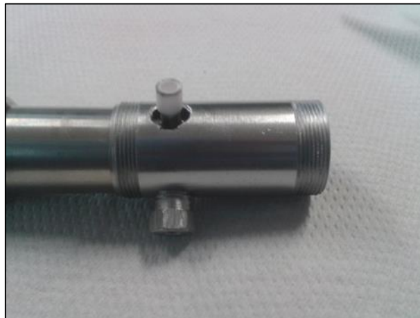
Figura A-22: Inserimento dell'isolatore in Allumina
