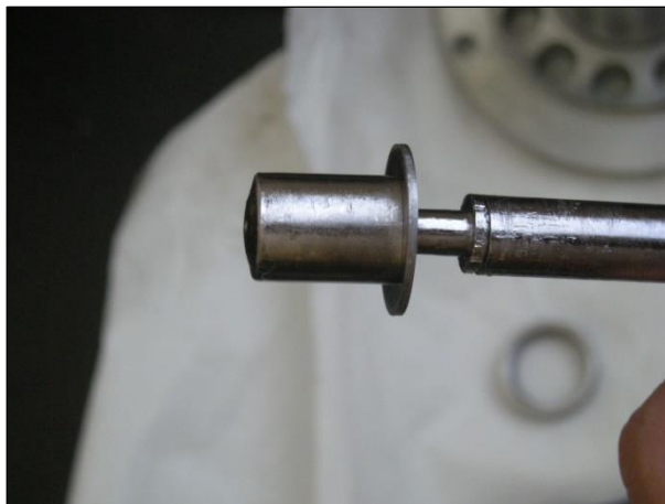
Figura 4-33: Catodo utilizzato per le prove HT, si nota la deformazione della faccia frontale
