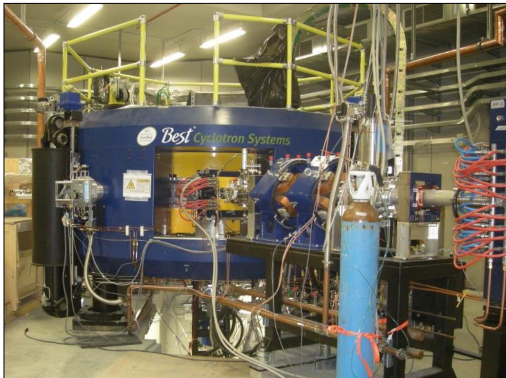
Figura 1-4: Il ciclotrone BEST® 70p.
