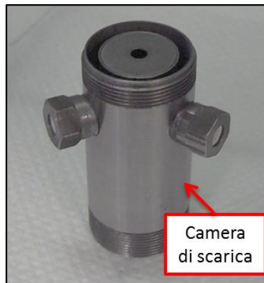
Figura 3-6: camera di scarica con anodo montato al suo interno attraverso il sistema di supporto.
