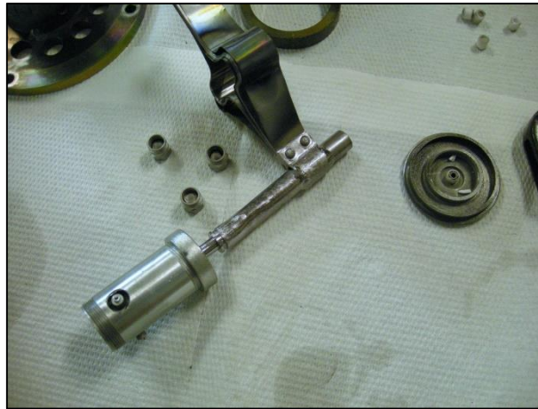
Figura A-5: Componente estratto dalla parte posteriore della sorgente. La transfer line risulta ben saldata al catodo
