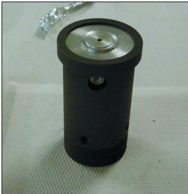
Figura A-31: Inserimento del pre assemblato anodo-catodo nel sistema di supporto
