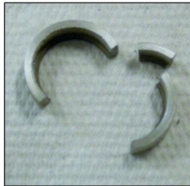
Figura A-6: Ghiera di fissaggio del catodo rotta
