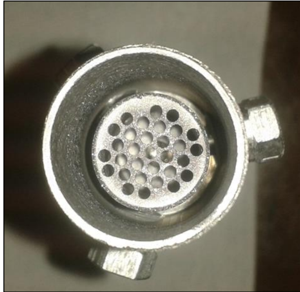
Figura A-25: Verifica dell'allineamento dell'anodo
