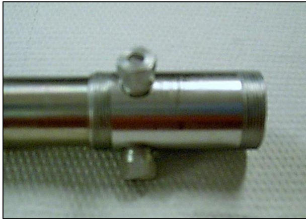
Figura A-24: Completamento dell'operazione di fissaggio dell'anodo
