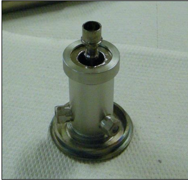
Figura A-30: Pre-assemblato anodo-catodo
