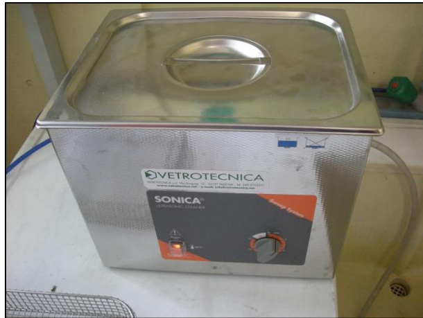
Figura A-10: Lavatrice ad ultrasuoni in fase di riscaldamento
