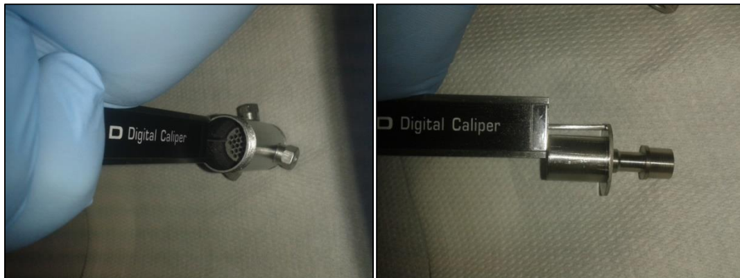
Figura A-26: Misurazione del gap tra anodo e catodo
