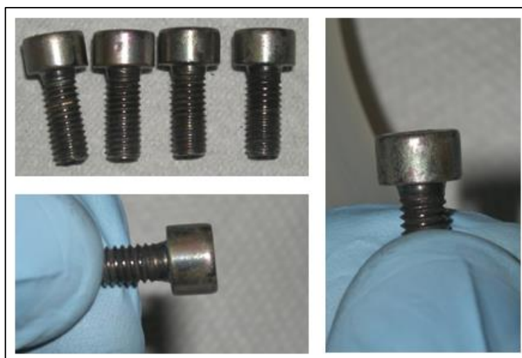
Figura 3-24: Viti rovinare dal riscaldamento
