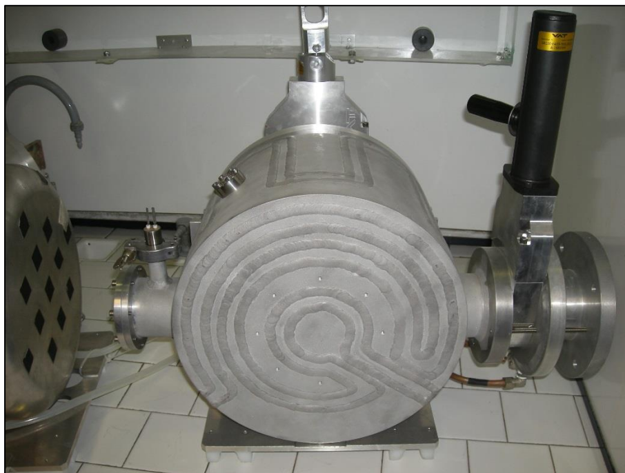
Figura 5-3: Camera da vuoto utilizzata per il Target . Si notano i canali di raffreddamento saldati sul coperchio.
