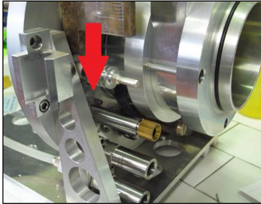
Figura A-17: Puntone del gas contenente il leak
