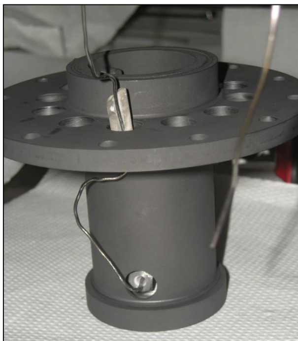
Figura A-37: Inserimento del filo di Tantalio per fornire la differenza di potenziale all'anodo
