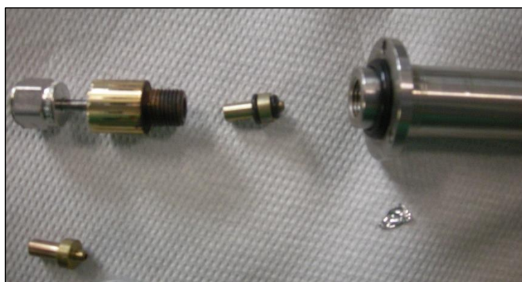
Figura A-20: Assemblaggio del leak
