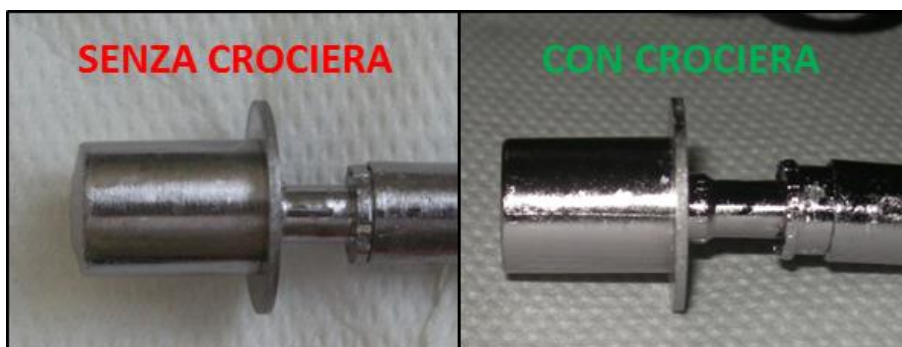
Figura 3-23: A sinistra il catodo utilizzato senza la crociera di allineamento in cui si nota lo spanciamento della faccia frontale. A destra un catodo utilizzato per le prove di efficienza che non ha presentato deformazioni plastiche (circa 40 cicli di riscaldamento e raffreddamento).
