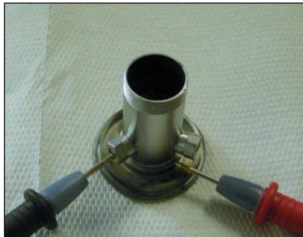
Figura A-29: Verifica dell'isolamento elettrico tra anodo e camera di scarica
