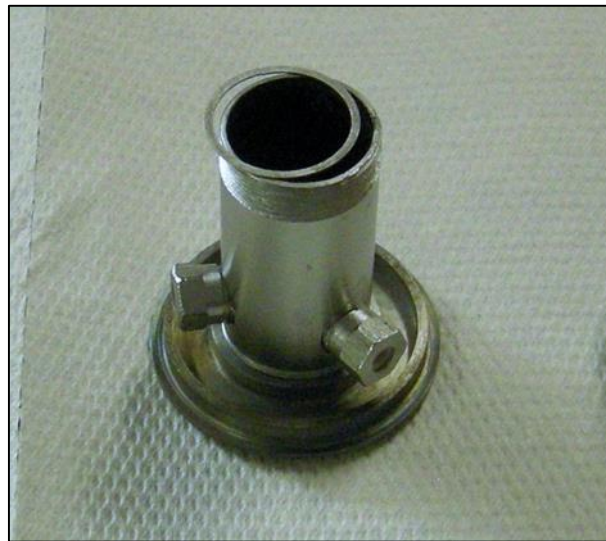
Figura A-28: Posizionamento dell'anello distanziatore (se necessario)
