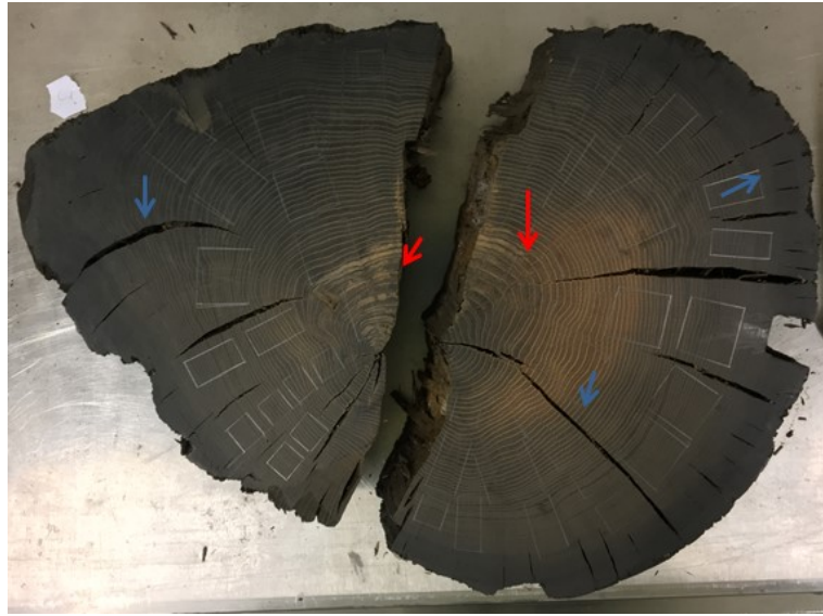
Figura 10. Tronco di quercia subfossile ritrovato nel canale Piavon. Rotella utilizzata nello studio (freccia rossa: zona con colore più chiaro; freccia blu: fessurazione del legno)
