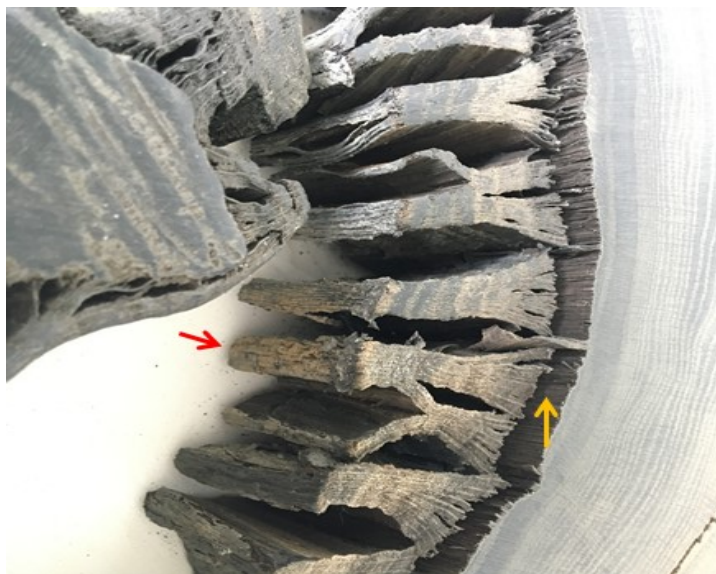
Figura 6. Tronco di quercia subfossile ritrovato nel fiume Zero. Rotella usata per esposizione (la freccia gialla indica la profonda fessurazione radiale con il relativo degrado; A indica la zona anulare degradata)
