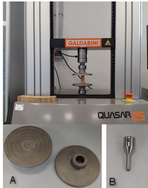
Figura 21. Macchina in fase di prova di compressione (sopra). A: piatti usati per la prova di compressione; B: punta emisferica per prova della durezza. Foto di Bolge L.
