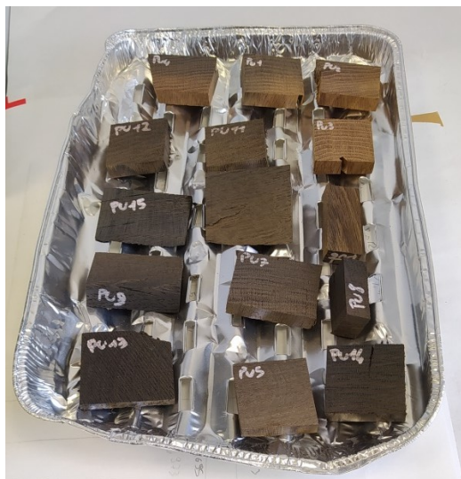
Figura 20. Campioni dal Piavon per il controllo dell'umidità assoluta, ognuno con indicato il nome per il riconoscimento della posizione.
