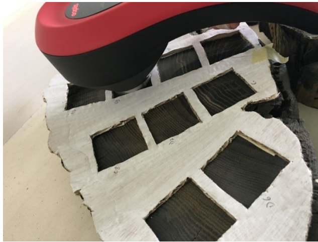
Figura 15. Posizionamento dello strumento all'interno della griglia.
