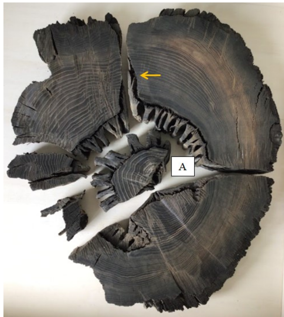
Figura 6. Tronco di quercia subfossile ritrovato nel fiume Zero. Rotella usata per esposizione (la freccia gialla indica la profonda fessurazione radiale con il relativo degrado; A indica la zona anulare degradata)
