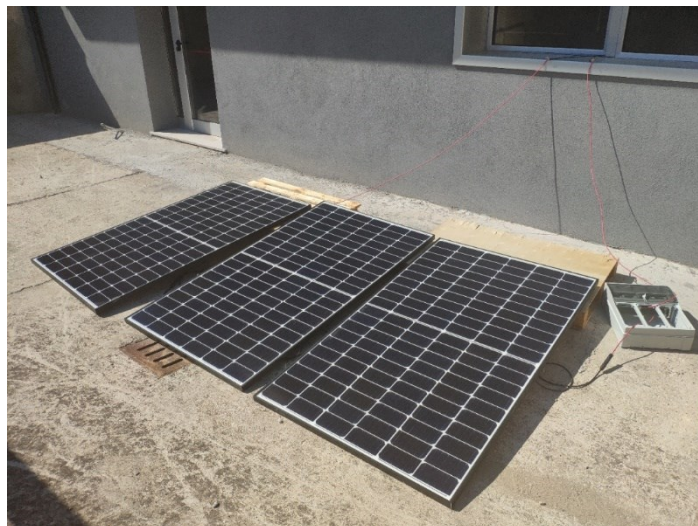
Fig.6.11 I tre pannelli fotovoltaici collegati in serie utilizzati per effettuare le misurazioni.
