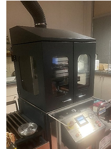
Pressa per piastratura presente in laboratorio tecnologico
