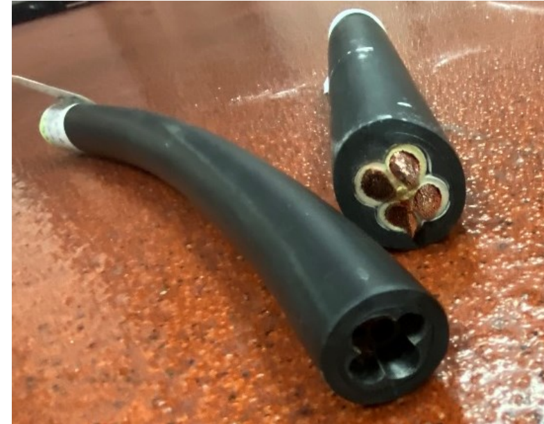
Sezione di un cavo con guainetta D21
