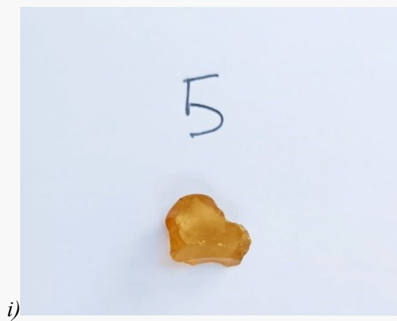
Figura 5. Immagini del campione di prova P5 prima (i) e dopo (l) la cottura in olio a 145°C.
