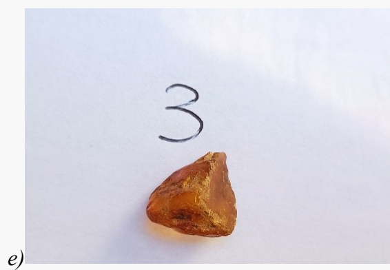
Figura 3. Immagini del campione di prova P3 prima (e) e dopo (f) la cottura in olio a 130°C.
