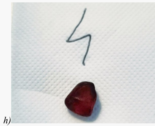
Figura 4. Immagini del campione prova P4 prima (g) e dopo (h) la cottura in olio a 140°C.
