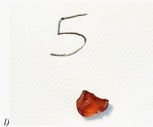
Figura 5. Immagini del campione di prova P5 prima (i) e dopo (l) la cottura in olio a 145°C.
