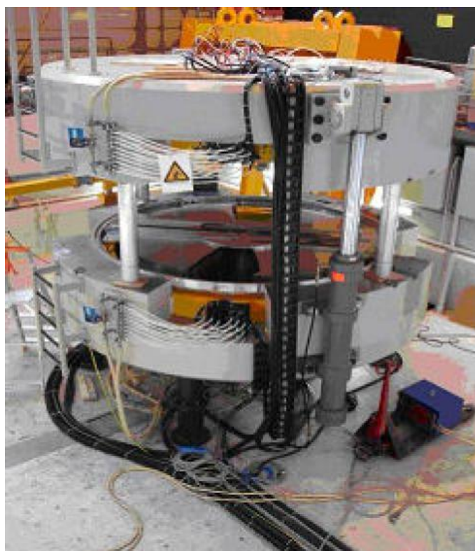
Figura 2.2: Il ciclotrone Cyclone 70 .
