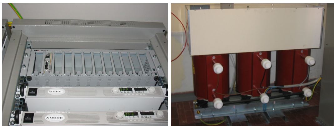
Figura 2.20: Dispositivi impiegati per l'isolamento della piattaforma di alto voltaggio: a sinistra il trasmettitore in fibra ottica per le trasmissioni dei dati, a destra il trasformatore di isolamento impiegato per disaccoppiare la linea di alimentazione della piattaforma di alto voltaggio dalla rete del laboratorio.
