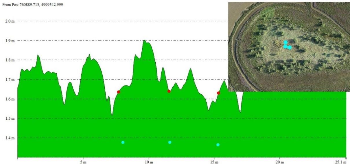
Fig. 1.2.6 - Esempio di confronto fra le quote altimetriche ottenute mediante palina GPS (in azzurro) e DEM 2023 (in rosso) per un'area coperta da vegetazione di duna nella barena 1.
