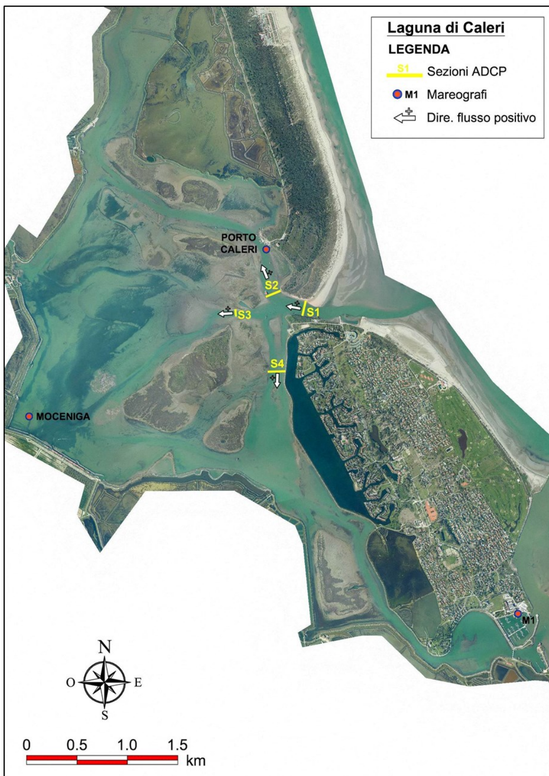
Fig. 3.4.2 – Campagna di misure del 14 settembre 2023. Posizione dei mareografi (M1, Porto Caleri e Moceniga) e dei transetti correntometrici ADCP. Le frecce indicano il verso positivo delle portate. Base: ortofoto volo LIDAR aprile 2018 Regione del Veneto, georeferenziata.
