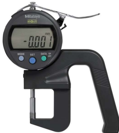
Figura 59: Spessimetro digitale Mitutoyo 547-401 Absolute Digimatic Thickness Gauge utilizzato per la misurazione dello spessore dei campioni.
