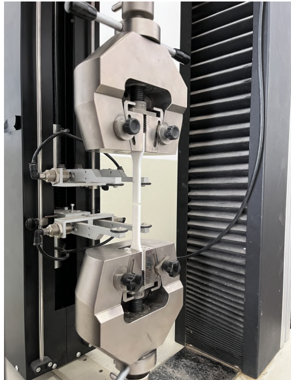
(b) Prova di trazione su un provino con layer trasversali
