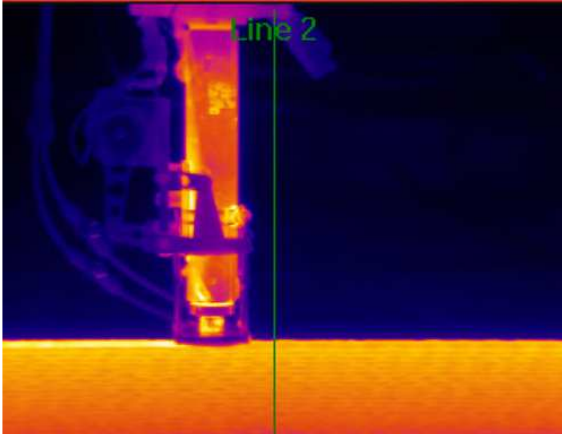
Figura 1.7: Analisi termica deposizione filamento
