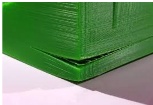
(b) Esempio di delamination
