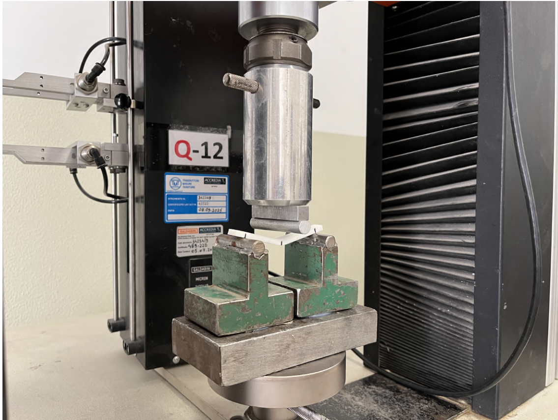
Figura 2.6: Provino in PLA con layer trasversali testato a flessione.
