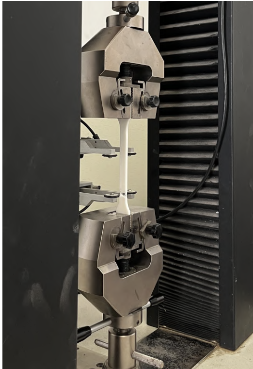
(a) Prova di trazione su un provino con layer longitudinali
