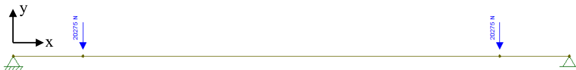
Figura 10: Schema di carico della guida lineare
