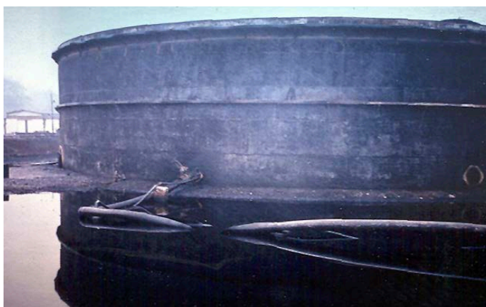
Figura 10.1: Fuoriuscita di liquido dalla sommità di un serbatoio cilindrico semi-interrato a causa dello sloshing.
