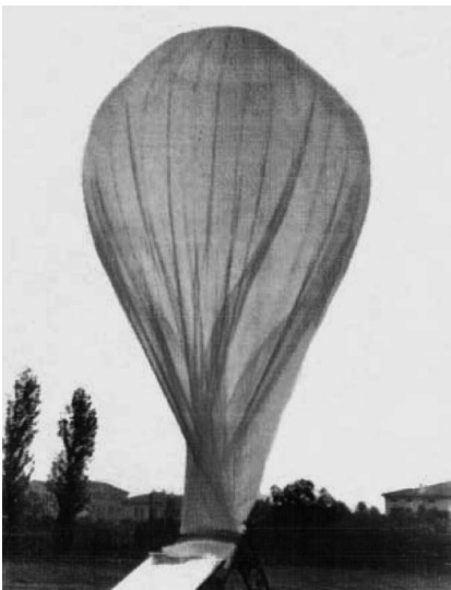
Figura 3.11: Un pallone in polietilene per le emulsioni ad alta quota
