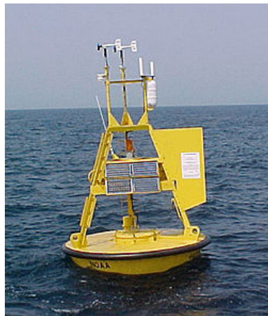
Figura 5: Tipica boa con apparecchiature scientifiche a bordo
