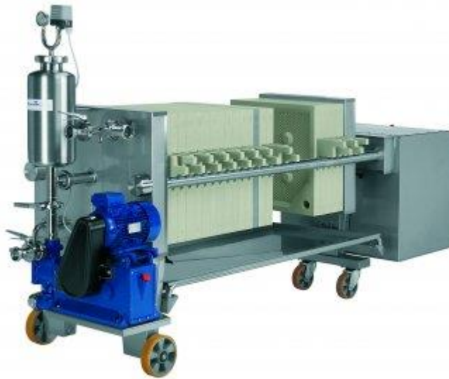
Filtro pressa con tele gommate in polipropilene 630x630 mm.
