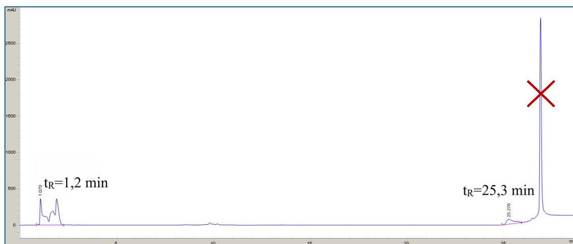
Figura 52 Profilo HPLC del peptide 5. Gradiente 0-3% B in 30 min, \lambda_{abs} = 220 nm.
