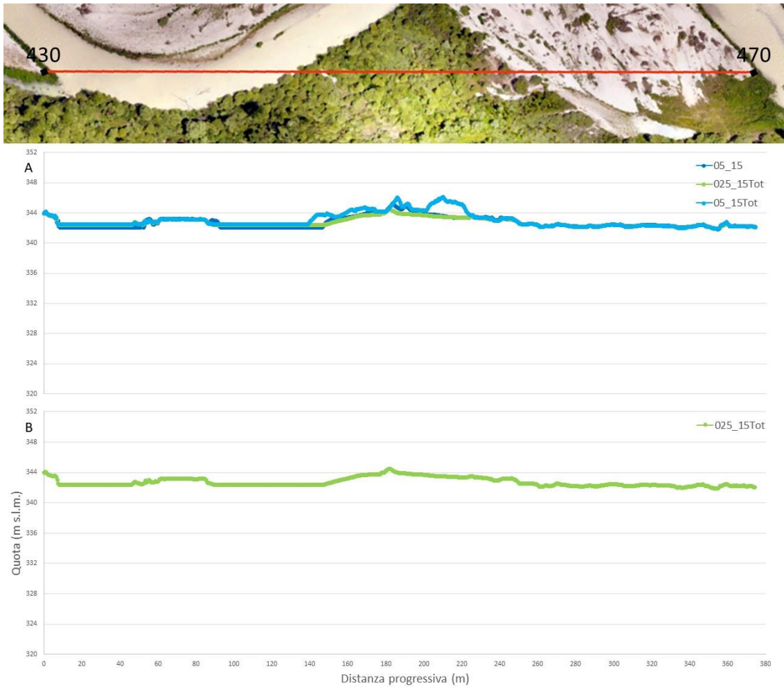
Figura 5.1.18: Analisi della sezione trasversale che collega i punti 430 e 470. Si riporta il confronto tra il risultato prescelto della figura 5.1.9 e i DTM elaborati con la totalità delle immagini(A); risultato prescelto(B).
