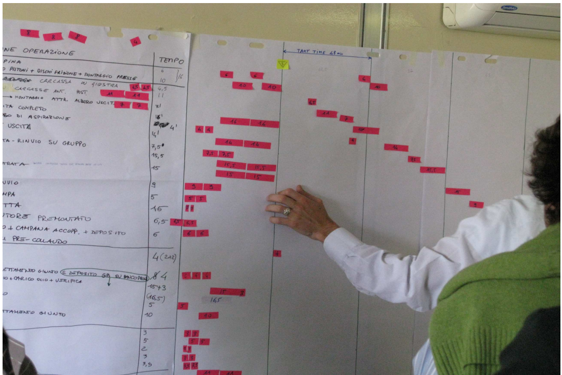
Figura 4.4.7 – Bilanciamento del carico di lavoro per postazione.
