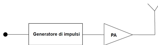
Figura 1.1: Schema di un trasmettitore a impulsi.
