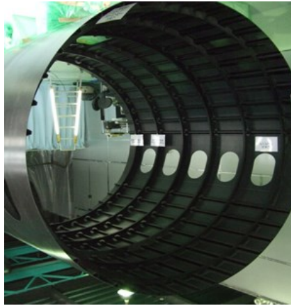
Fig.1.5: Sezione di una fusoliera realizzata in polimero rinforzato con fibra di carbonio.
