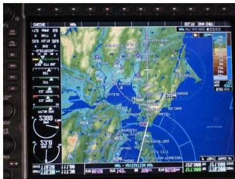
Fig.3.3: Uno schermo MFD di un Garmin G1000 che mostra indicazioni di navigazione e i diversi parametri di funzionamento del motore. [www.wikipedia.org]
