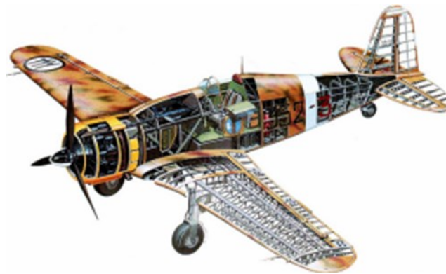
Fig.1.7: Struttura di un Fiat G50, caccia della Seconda Guerra Mondiale.
