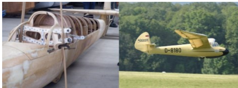
Fig.1.11: Aliante Minimoa, realizzato in legno. [www.aerosoft.com]
