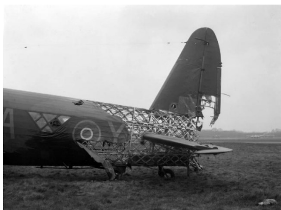
Fig.2.7: Fusoliera a struttura geodetica di un Vickers Wellington, danneggiato durante la II Guerra Mondiale. [www.wikipedia.org]
