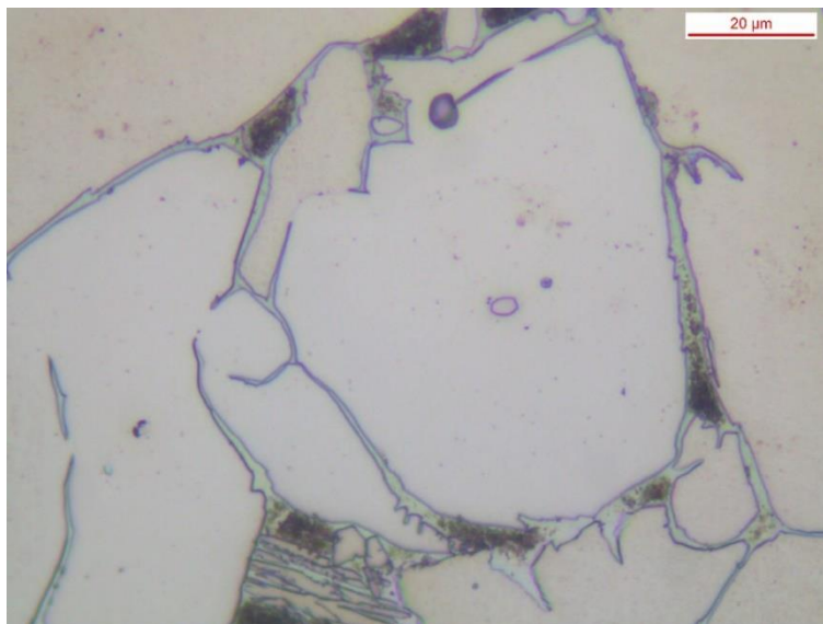
Figura 4.12. Particolare di un grano equiassico (fase \alpha ) nel quale si distingue un carburo precipitato a centro grano (colore viola) e fase \beta a bordo grano
