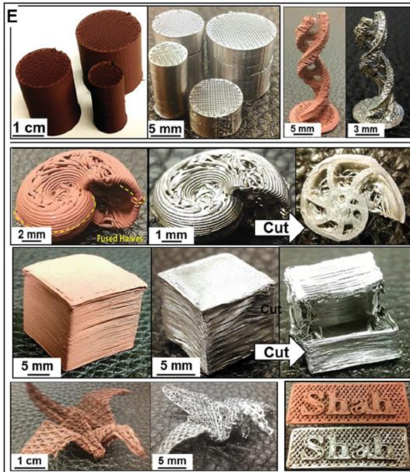
Figura 2.14. Geometrie stampate con la tecnica del DIW pre e post sinterizzazione [18]
