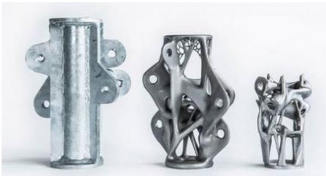
Figura 1.5. Giunto metallico sottoposto a redesign. A sinistra prodotto con metodi tradizionali, al centro stampato in 3D con minore utilizzo di materiale, a destra ulteriore implementazione con scalatura
