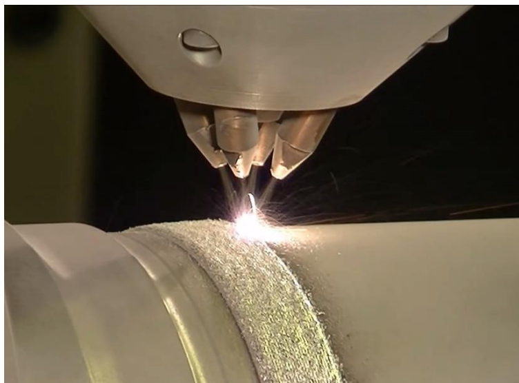
Figura 2.6. Processo di stampa DED. Particolare della deposizione del materiale e della testina di stampa con 4 ugelli
