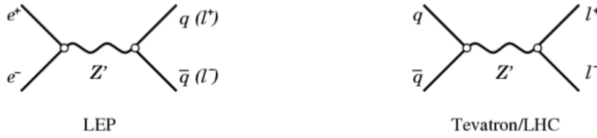
Figura 1.1: Meccanismo di produzione della Z' a LEP (collisioni e^+e^- ) e a Tevatron (collisioni p\bar{p} ) / LHC (collisioni pp ).
