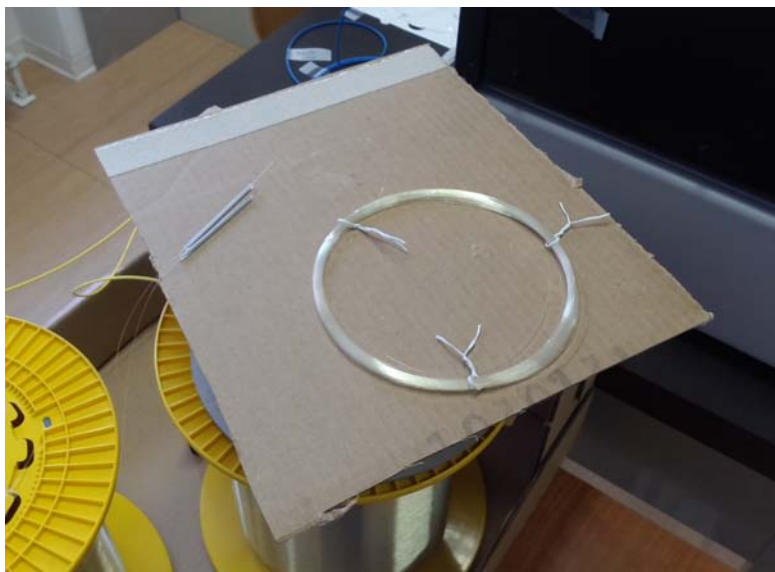
Figura 3.21: Dettaglio sulla sezione di fibra che subirà le variazioni di temperatura.
