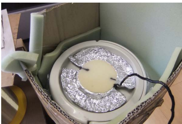
Figura 3.22: Dettaglio del thermos in cui è presente l'acqua e la sezione di fibra.
