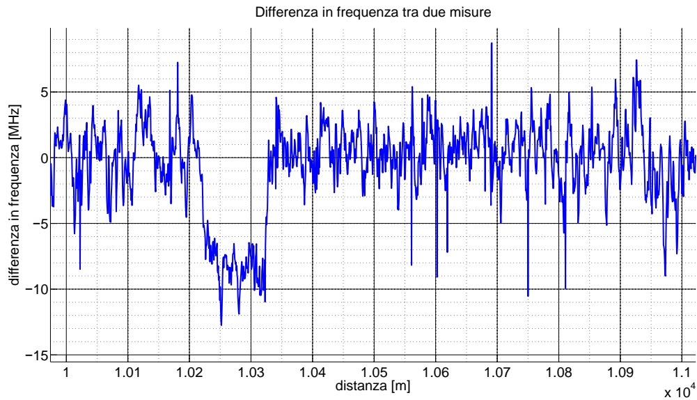
Figura 4.17: Differenza tra la traccia del file AtoB_ 15T e quella di riferimento. Zoom sulla sezione di fibra la quale è ad una temperatura di di 17.5 °C.
