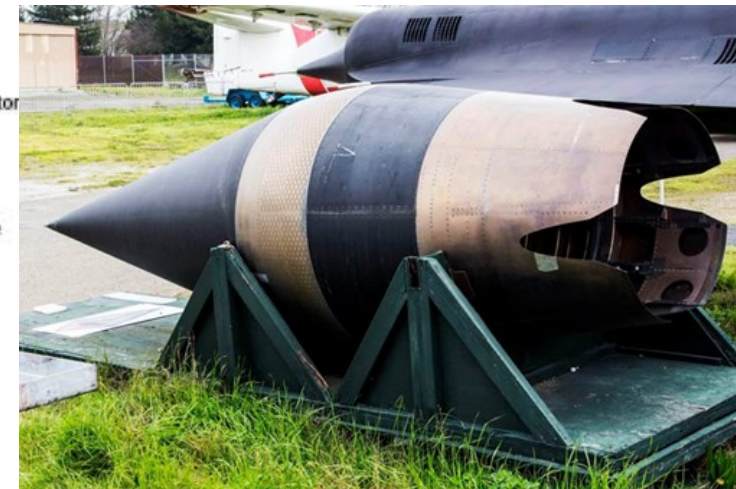
Foto della spina conica nel suo complesso [4]
