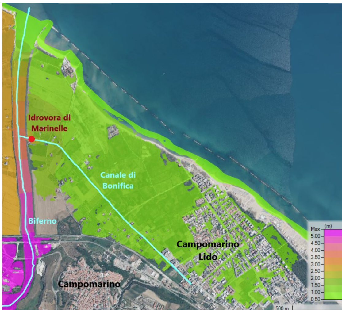
Figura 99 - Scenario tempo di ritorno 30 anni: carta della quota massima raggiunta dagli allagamenti in corrispondenza di Campomarino Lido.
