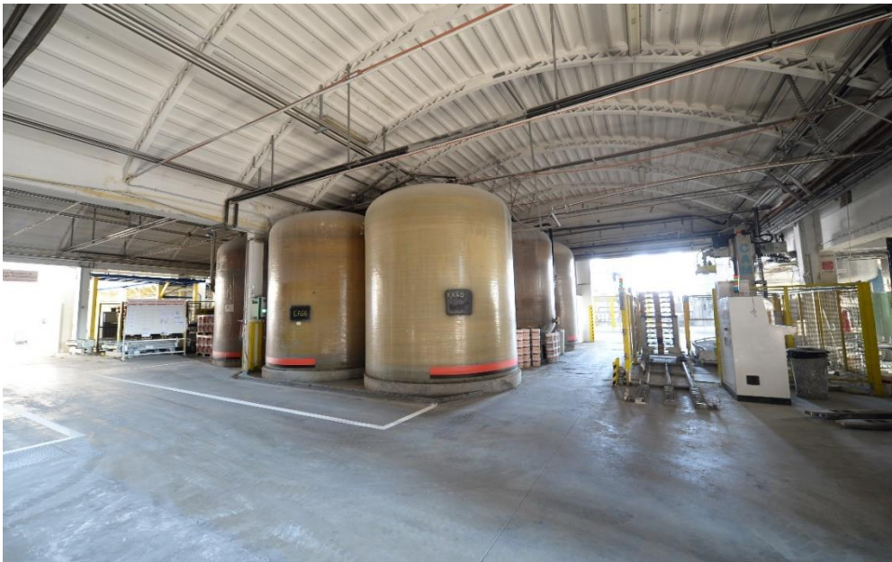
Figura 3.5 - Silos contenenti le resine ed a destra è visibile il pallettizzatore del Reparto Vecchio.
