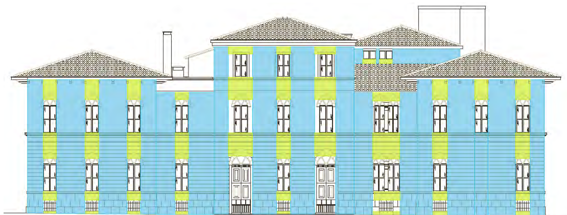
Figura 4.03: Individuazione dei maschi murari e delle fasce di piano nel prospetto sud.
