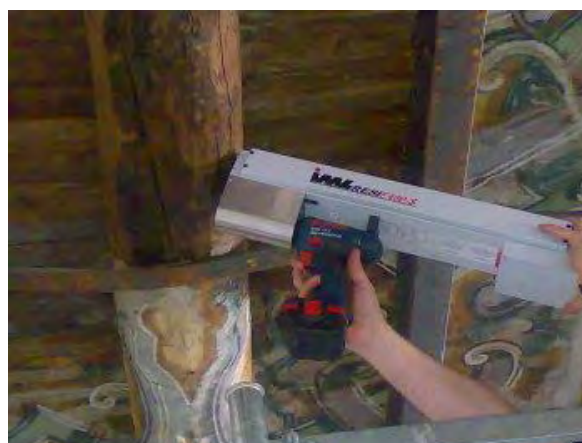
Figura 9.07: Igrometro a punte sulla sinistra con terminale di rilevamento e immagine di una prova in svolgimento.
