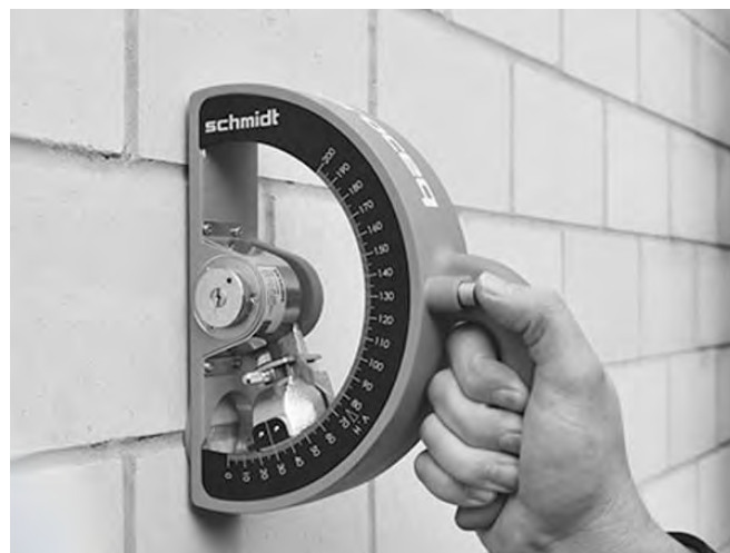
Figura 9.04: Sclerometro per prove su CA.
