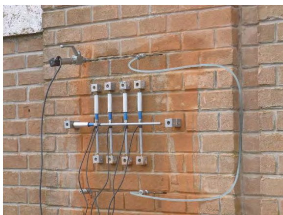
Figura 9.02: Disposizione dei martinetti e degli strain gage sulla muratura, con un grafico tensione-deformazione per la prova del martinetto doppio.
