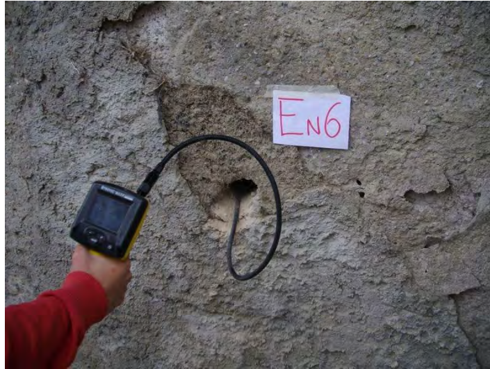
Figura 9.08: Prova endoscopica in svolgimento con visore collegato all'estremità.
