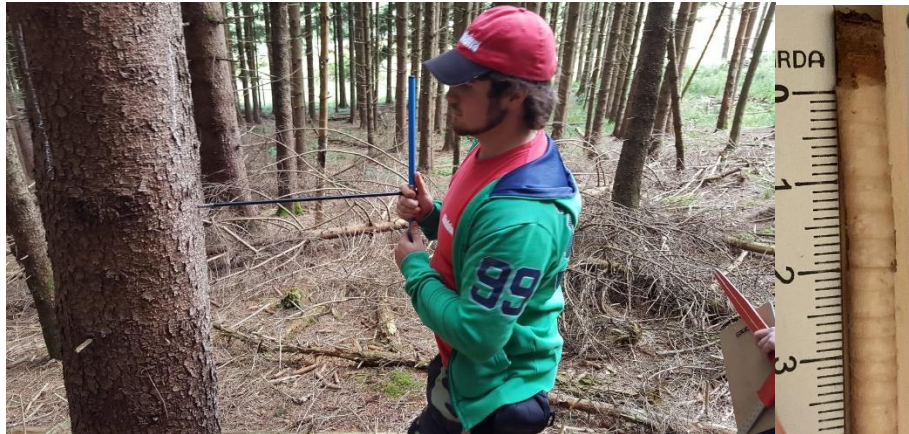
Fig 5.2.2: Utilizzo del succhiello di Pressler e carota ottenuta
