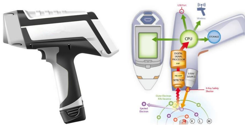
Fig 4.1.1.4 e 4.1.1.5: Spettrometro portatile in lega a fluorescenza dei raggi x moderno
