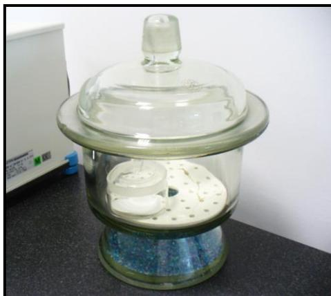
**Contenitore con silice colloidale essiccata utilizzato per lo stoccaggio dei filtri**
