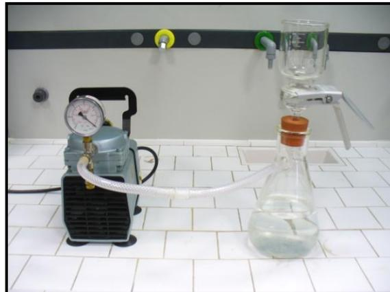
Fig.1 "Strumentazione per il filtraggio"
