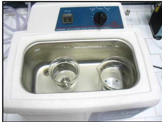
Fig.2 "Vasca di lavaggio ad ultrasuoni"
