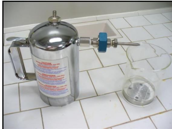
Fig.3 “Apparecchio per il lavaggio con getto in pressione”
