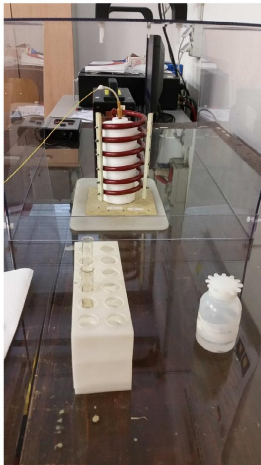
*Figura 5.7 – Sonda in fibra ottica OPTOCON inserita all'interno della provetta di MNPS, collocata nel cilindro in teflon. Accanto vi sono un test tube rack e una boccetta di isopropanolo.*
