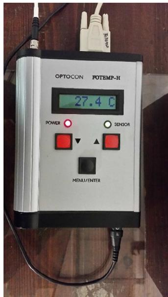
Figura 5.5 – Termometro digitale OPTOCON FOTEMP-H.
