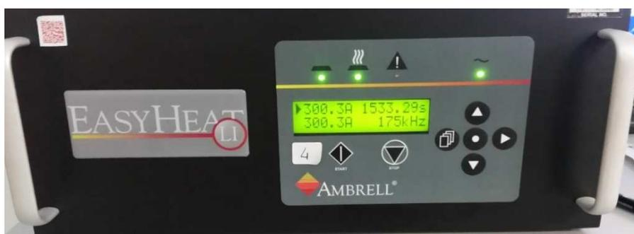
*Figura 5.3 – Pannello di controllo frontale del generatore Ambrell EASYHEAT LI 5060.*
