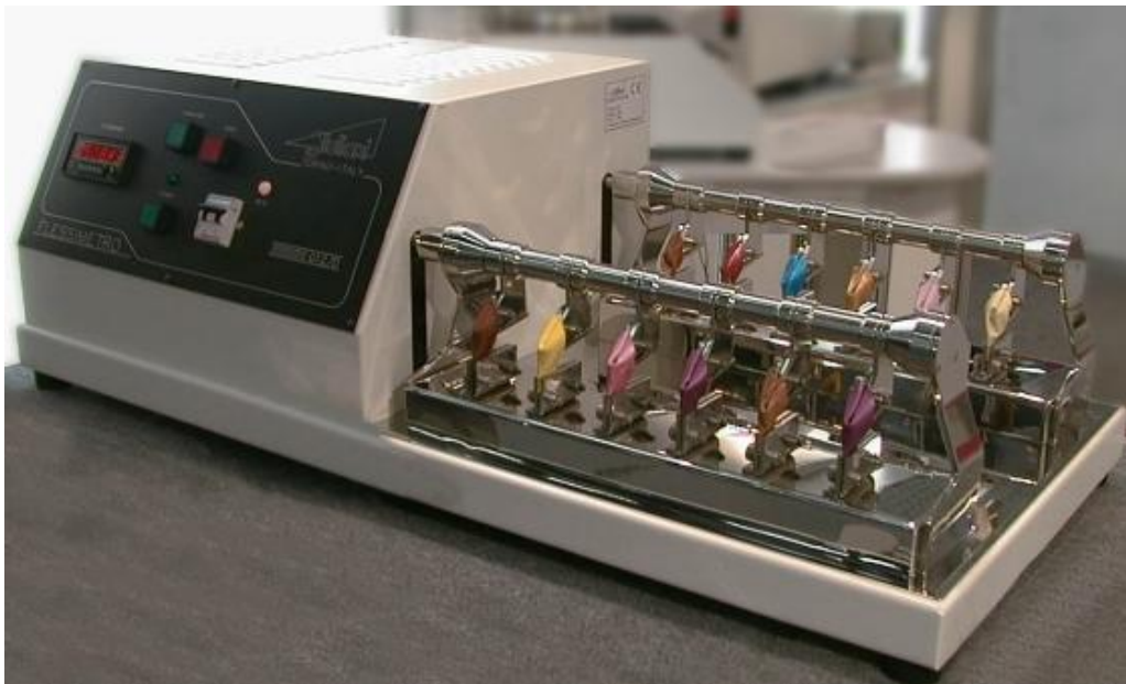
Figura 4.18: Flessimetro Bally a temperatura ambiente con provini rettangolari di tomaia.
