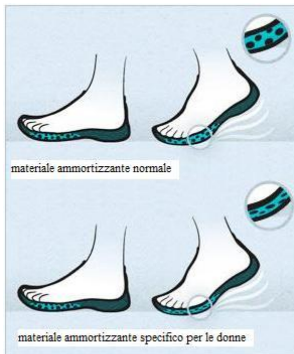
Figura 2.20: Diverso materiale ammortizzante utilizzato per calzature femminili.
