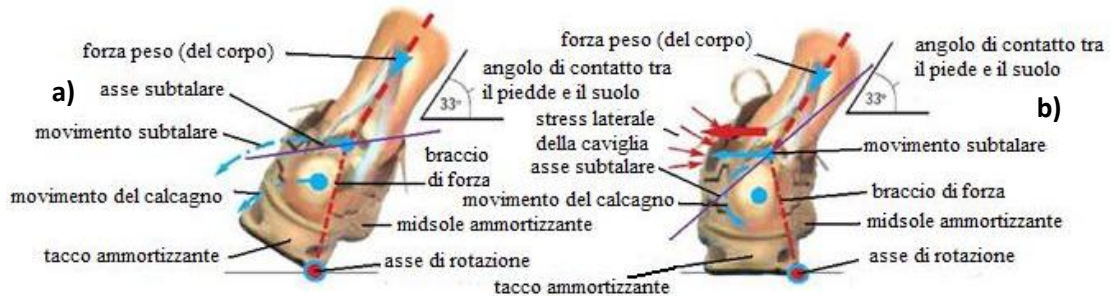
Figura 2.23: Scarpa con contrafforte basso. a): al momento del contatto con il suolo.
