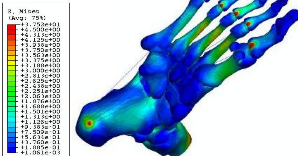
Figura 5.16: Tensione von Mises (pura compressione).
