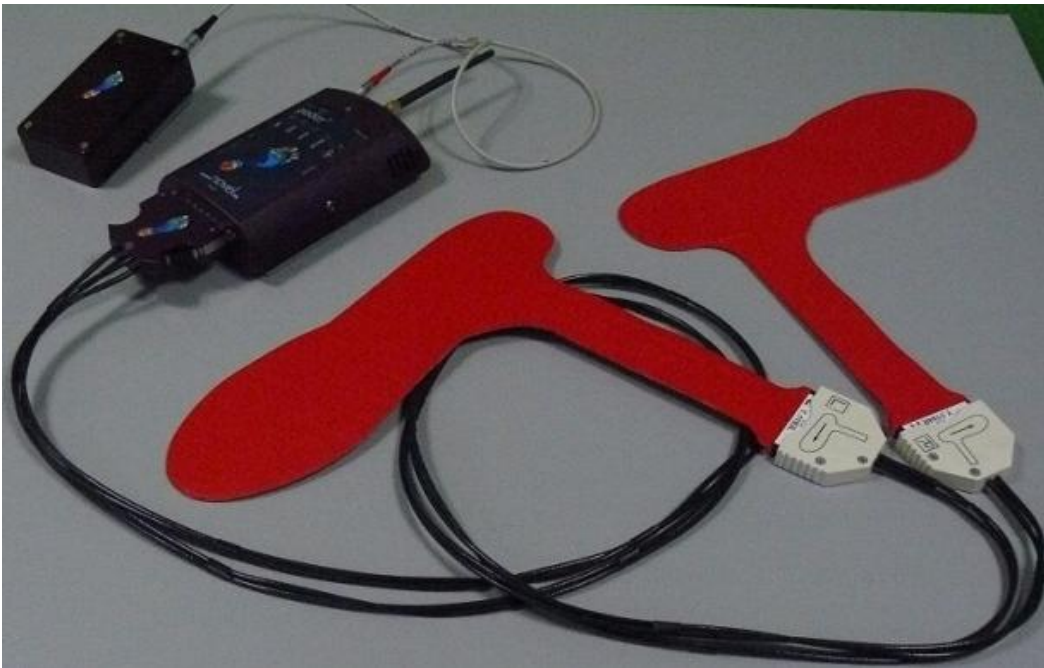
Figura 5.21: Solette sensorizzate PEDAR ® prodotte da NOVEL ® .
