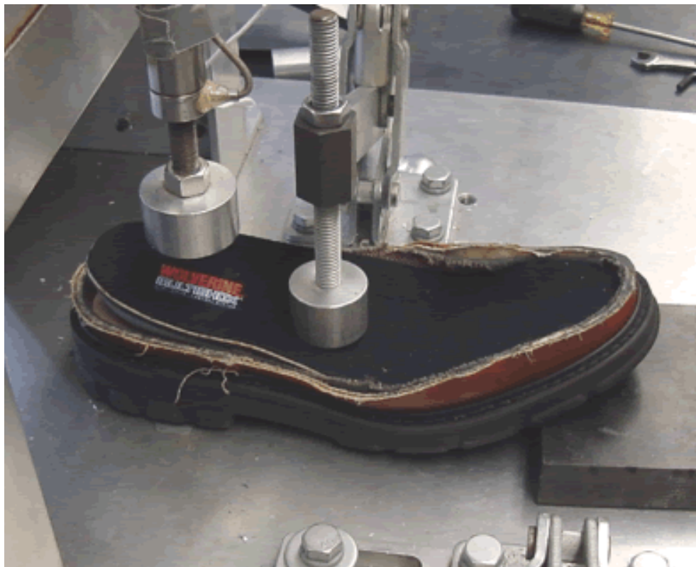
Figura 4.21: Prova di durezza effettuata su una suola completa.
