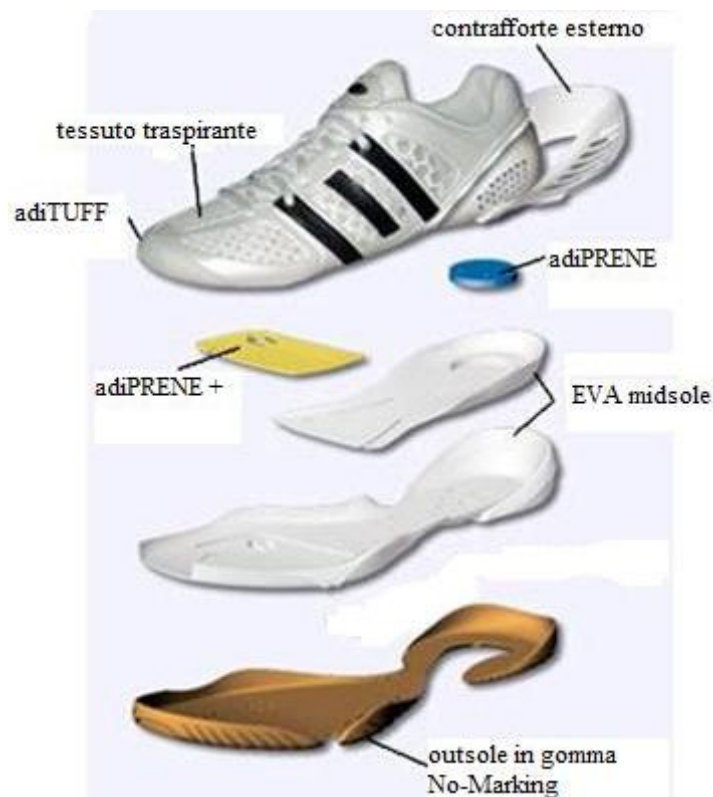
Figura 2.16: Parti di una calzatura sportiva con sistemi ammortizzanti (adiPRENE e adiPRENE+).
