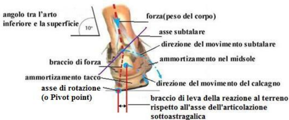
Figura 2.21: Scarpa con midsole ammortizzante al momento di contatto con il suolo.
