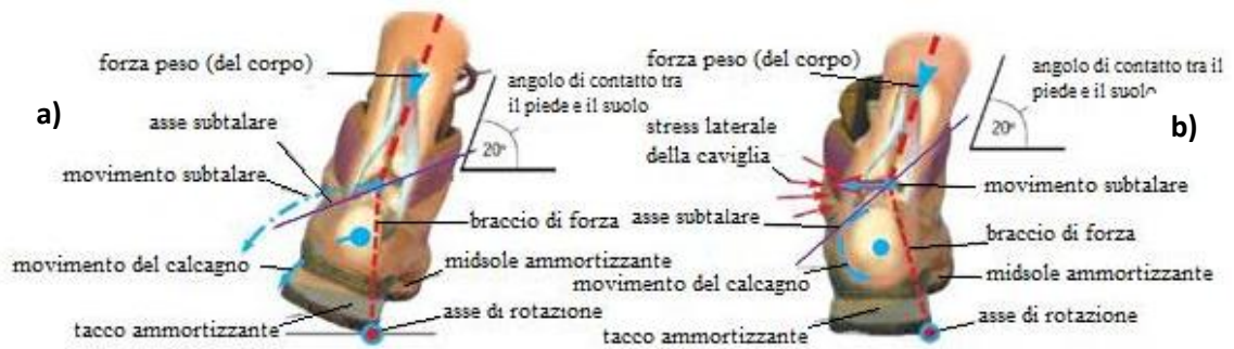
Figura 2.22: Scarpa con contrafforte alto. a): al momento del contatto con il suolo.
