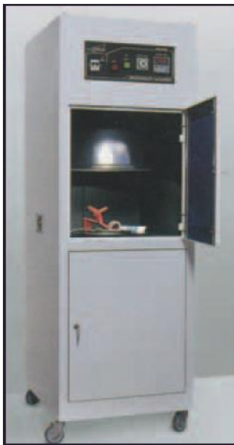
Figura 4.12: Apparecchio per la determinazione dell'impermeabilità del cuoio della suola.
