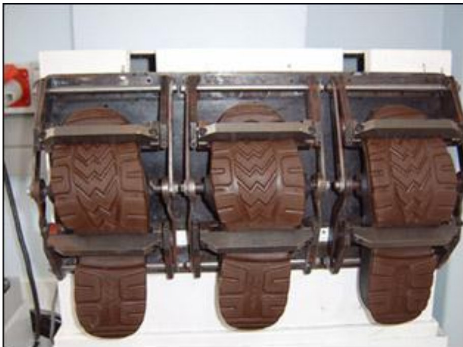
Figura 4.20: Test su soles di calzature con flessimetro Bennewart.
