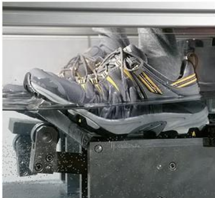
Figura 4.17: Analisi della permeabilità all'acqua della calzatura sportiva.
