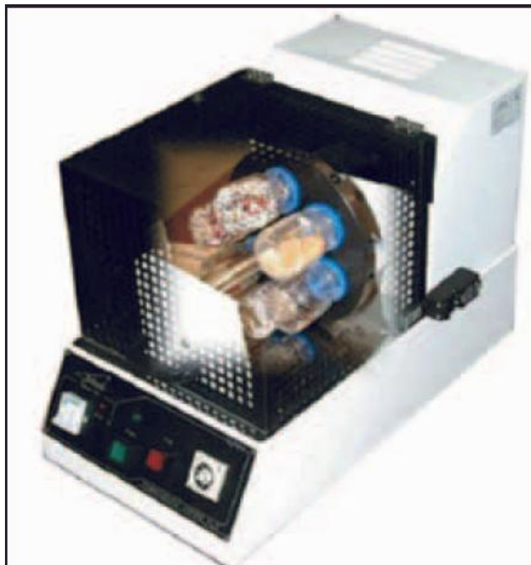
Figura 4.14: Apparecchio per la determinazione della permeabilità al vapore d'acqua.
