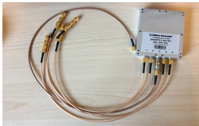
Figura 6: Splitter, annessi cavi SMA e attenuatore in ingresso
