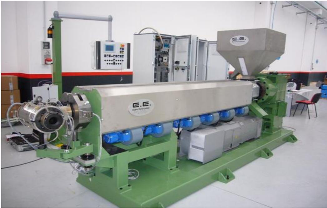
Figura 1.23. Linea di estrusione delle resine.
