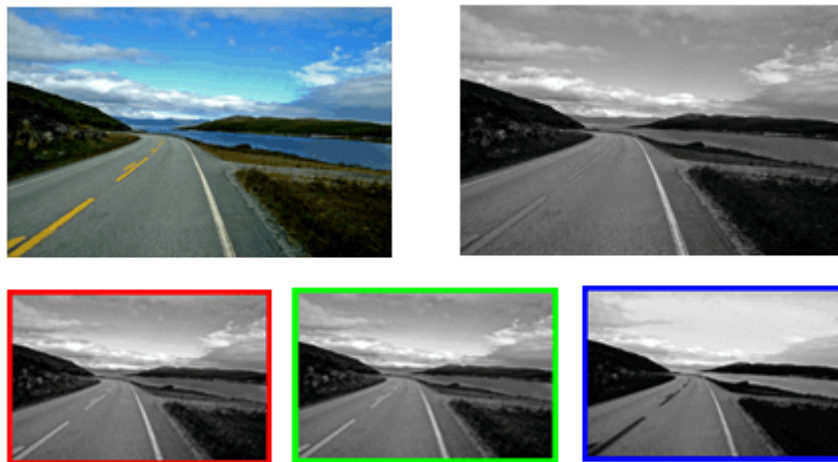
Figura 1.2 Nella fotografia nell'angolo in alto a sinistra si vede l'immagine con i colori originali, alla sua destra la versione in bianco e nero, sotto le tre versioni monocromatiche generate da ogni singolo canale R, G e B
