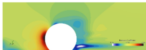
Figura 3.12: Coefficiente di Pressione Statica nella sezione della ruota
