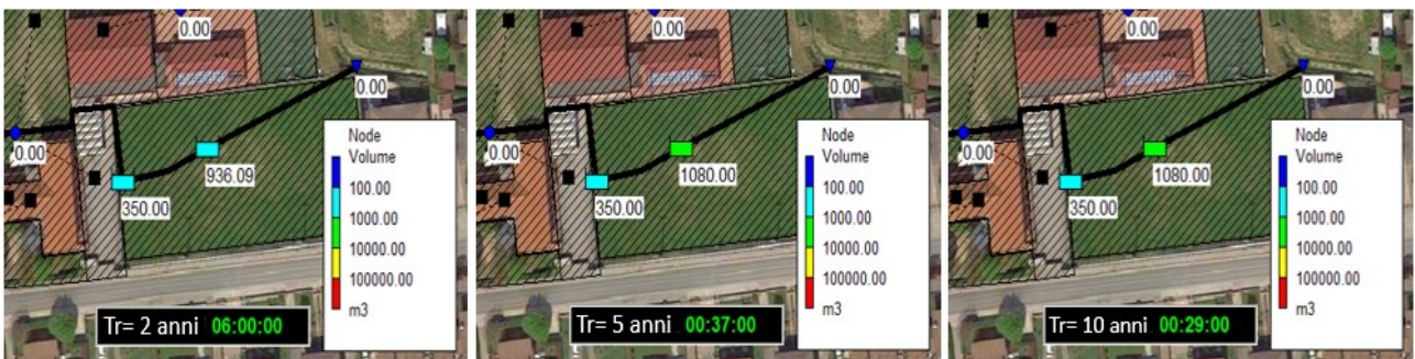
Figura 36: Grado di riempimento del sistema di accumulo per precipitazioni con Tr=2 anni, Tr=5 anni, Tr=10 anni.
