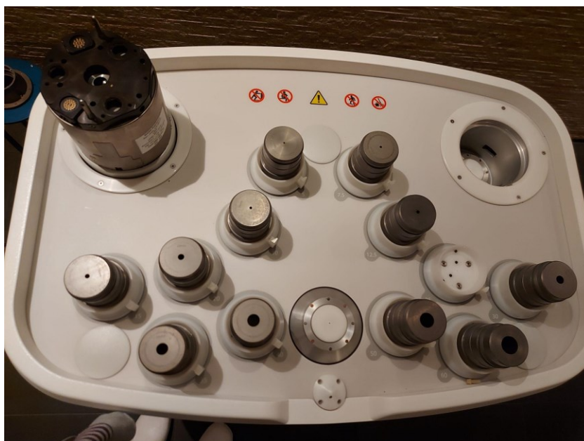
Figura 3. 5 Dispositivo robotico di sostituzione del collimatore Xchange
