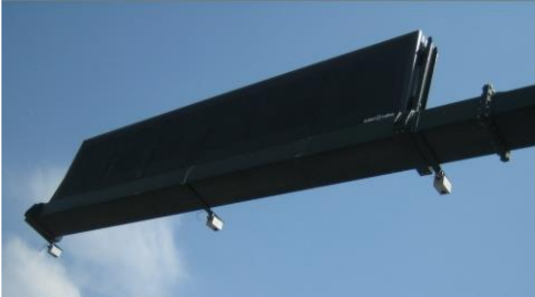
Figura 3.6 - Esempio di installazione di sensori ad ultrasuoni.
