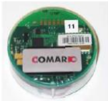
Figura 3.4 - Sensore wireless per il rilevamento del campo magnetico.
