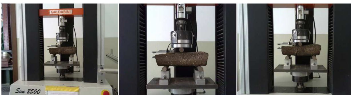
Figura 18 Tre fasi della prova a flessione sul refrattario pre-colata.
