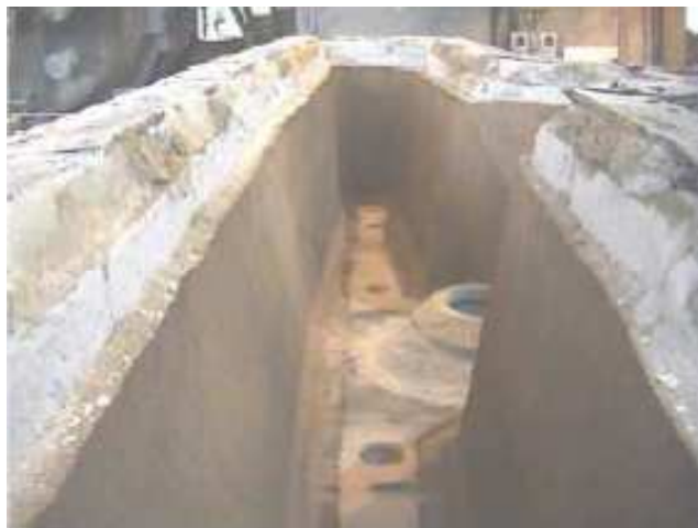
Figura 2 Paniera pronta per la colata, a centro è possibile osservare la presenza del Turbo-stopper.
