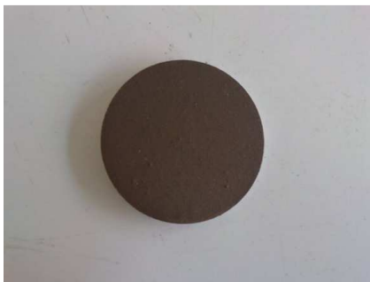
Figura 8 Pastiglia pronta per l'analisi XRF.
