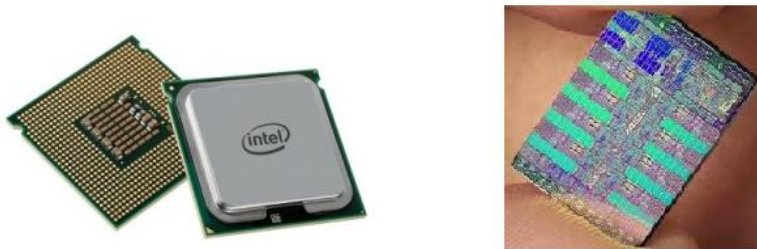
Figura 1.10: A sinistra il processore Xeon serie-5400 di Intel con tecnologia CMOS a 45nm. A destra il processore Cell di IBM, realizzato in tecnologia CMOS a 45 nm, in collaborazione con Sony, e utilizzato in svariati dispositivi tra cui le famose console da gioco Xbox 360 e PlayStation 3.
